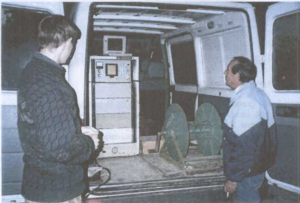
Foto 3. Tambor de cable instalado fijo en el interior del vehículo de campo
